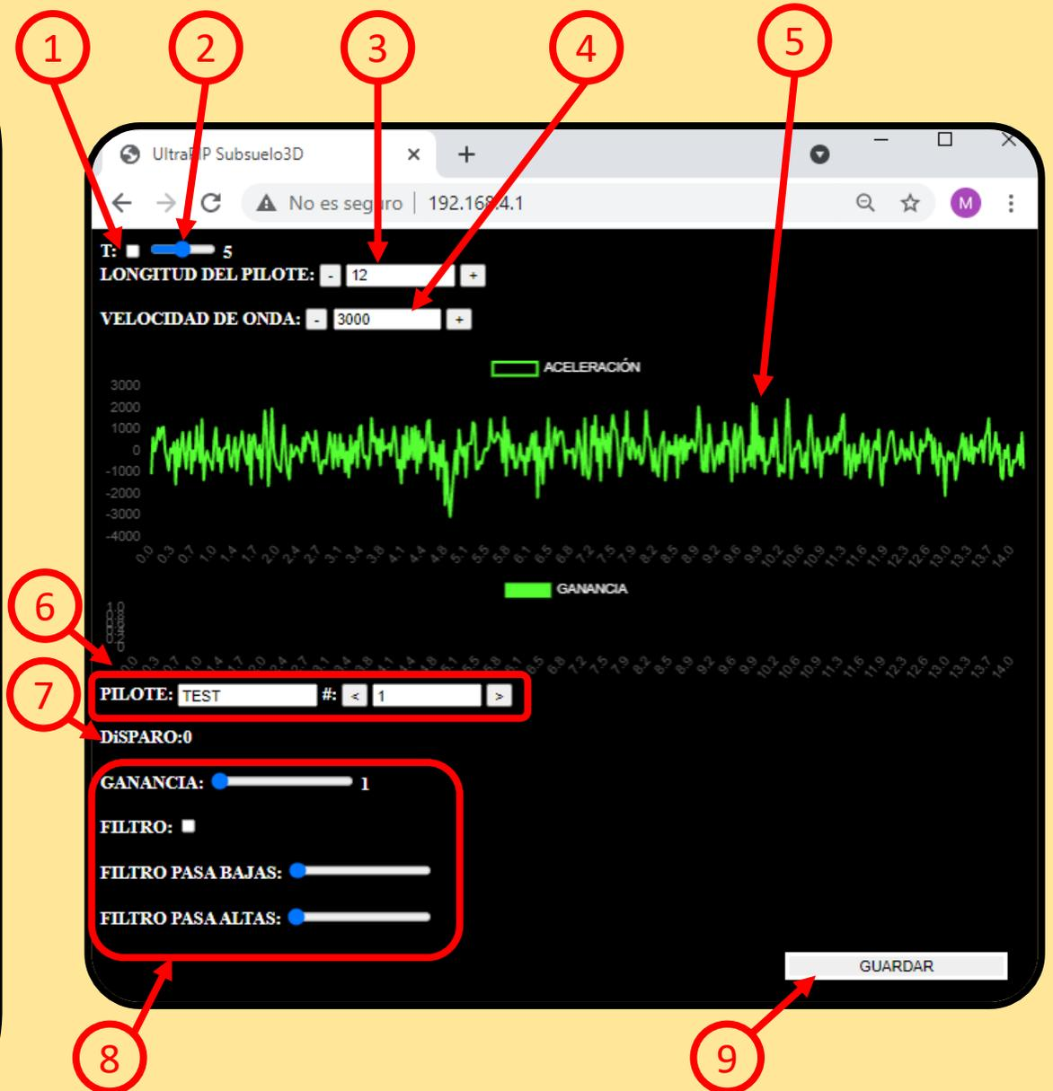
Una vez configurados los todos los parámetros, se procede a activar el trigger y así se puede impactar la cabeza del pilote con el martillo. Se obtendrá una señal como la que se muestra en la imagen.
